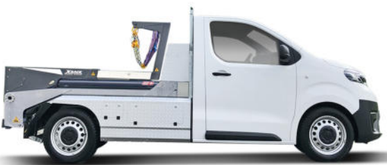
TOYOTA PROACE Platform 4x2 mit X-RACK eco1 a.A. möglich als Electric a.A möglich als Peugeot Expert, Citroen Jumpy, Fiat Scudo, Opel Vivaro
